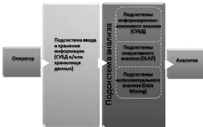
Рис. 2. Обобщенная архитектура системы поддержки принятия решений
