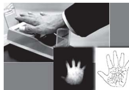
Сканер ладони, инфракрасный снимок и выделенная структура вен
