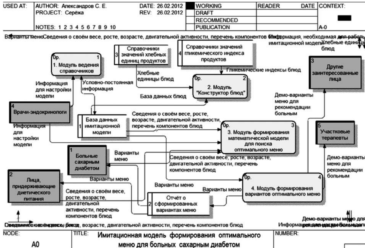
Рис. 3. Диаграмма потоков данных второго уровня, отражающая модульную структуру программного обеспечения имитационной модели
